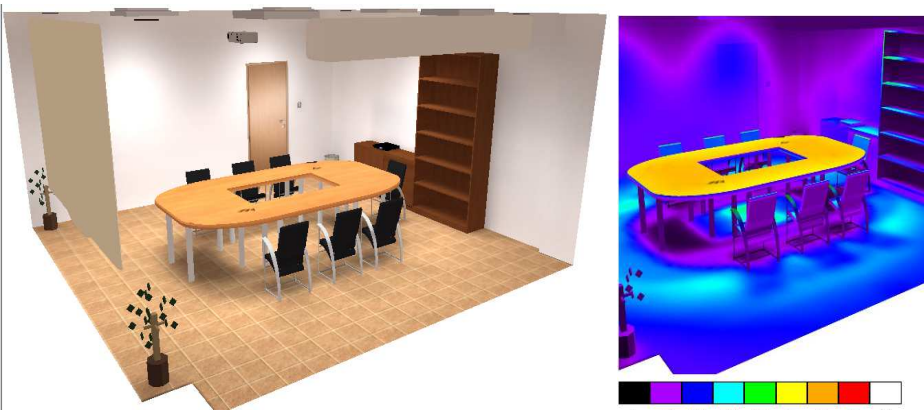
Rysunek 3. Przykładowa wizualizacja oświetlenia pomieszczenia biurowego – sala posiedzeń (a) i rozkład natężenia eksploatacyjnego oświetlenia (b).
